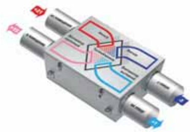
Рисунок 2.22 – Принципова схема утилізаційного теплообмінника в системі припливно-витяжної вентиляції
