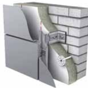
Рисунок 2.3 – Утеплення стін за методом «вентильованого фасаду»
