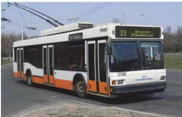
Рисунок 2.36 – Тролейбус АКСМ-221 із тиристорно-імпульсною системою керування тяговими двигунами
