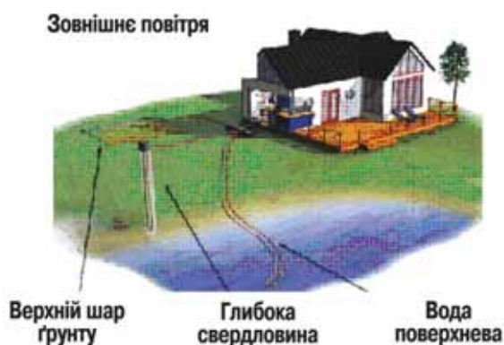
Рисунок 2.30 – Тепловий насос як джерело енергії
