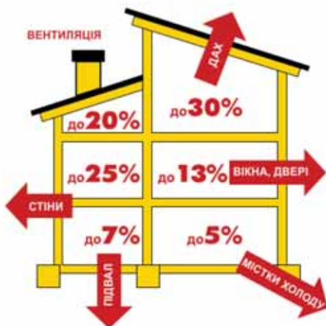
Рисунок 2.1 – Орієнтовний розподіл втрат тепла будівлею
