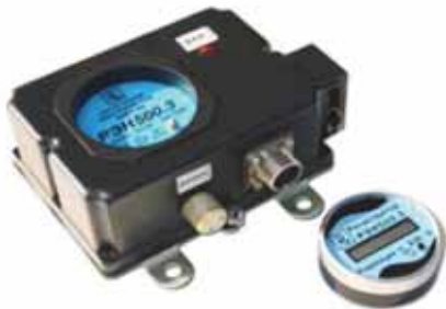
Рисунок 2.35 – Лічильник-реєстратор для обліку витрат електроенергії тяговими електродвигунами
