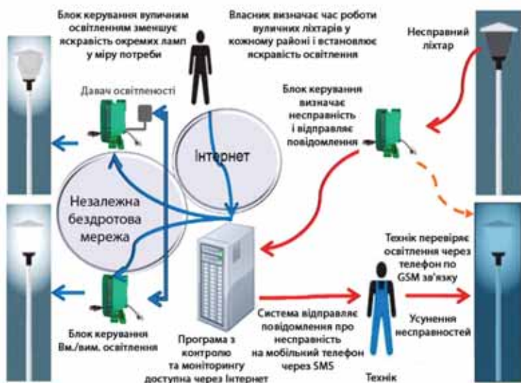
Рисунок 2.55 – Структурна схема інтелектуальної системи управління зовнішнім освітленням
