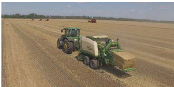
Рисунок 5.8 – Робота прес-підбирача великогабаритних тюків Krone Big Pack 1290 під час заготівлі соломи для Проекту USAID «Місцеві альтернативні джерела енергії: м. Миргород»
