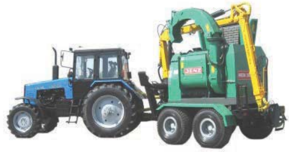
Рисунок 5.25 – Машина рубальна «Беларусь» МР-25 із барабанним багатоножовим ріжучим механізмом
