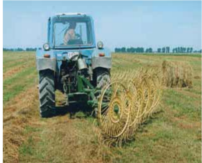
Рисунок 5.6 – Граблі для формування та здвоювання валків
