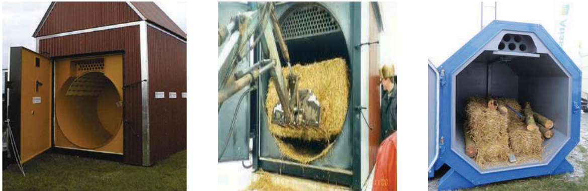
Рисунок 4.14 – Твердопаливний біокотел із можливістю механічного завантаження біопалива
