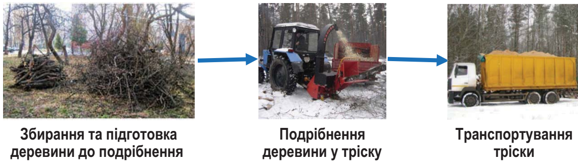
Рисунок 3.11 – Схема організації виробництва тріски
