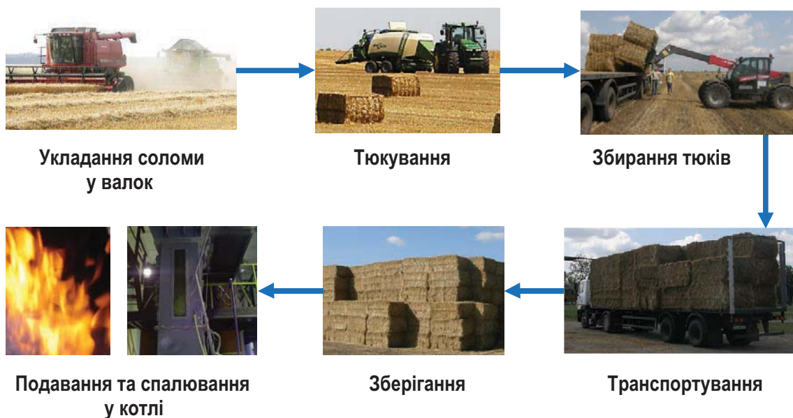
Рисунок 3.9 – Схема організації виробничого процесу по заготівлі та використанню соломи
