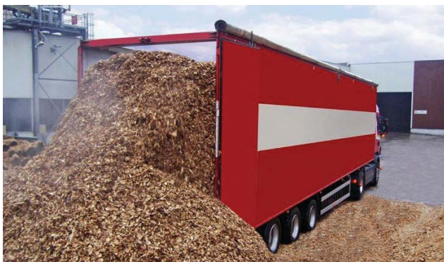
Рисунок 5.31 – Вивантаження напівпричепа трісковоза із системою рухомого дна
