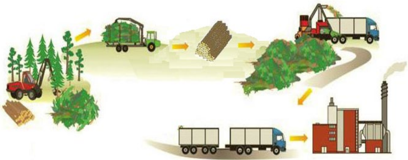
Рис. 2.2.1. Принципова схема логістики тріски.
