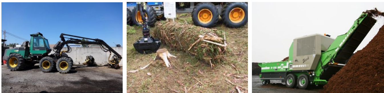
Рис. 2.4.2. Зліва направо: харвестер, в'язанки відходів рубки, мобільний подрібнювач.
