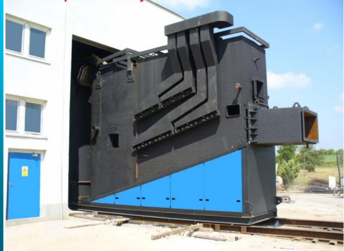
Kotel na spalování slámy 5 MW
