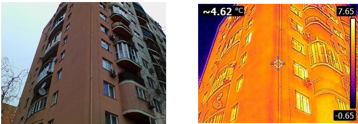
Рис. 4.2 Приклади результатів обстеження будівель тепловізором (початок)
